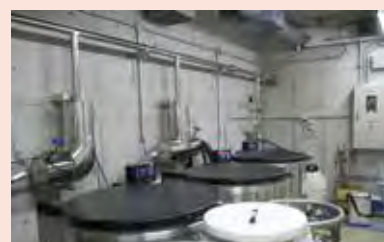
B1 さい帯血保管室/液体窒素タンク
